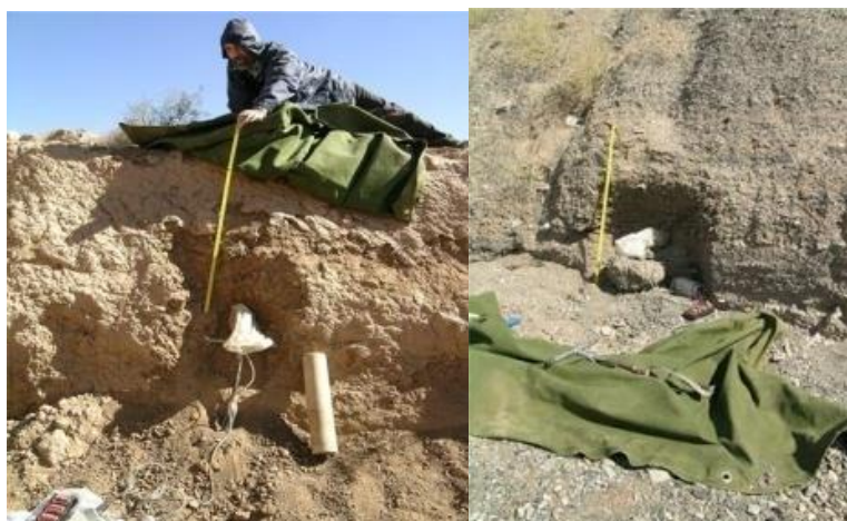
شکل ۸. دوزیمتری با استفاده طیف‌سنج گامای قابل حمل.
