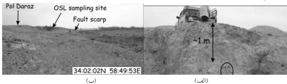
شکل ۷. نمونه‌برداری با استخراج بلوک از منطقه پل دراز در شمال شرق ایران جهت سن‌یابی لومینسانس نوری (الف) محل نمونه‌برداری در منطقه پل دراز. (ب) محل برداشت بلوک از زیر فلش.
