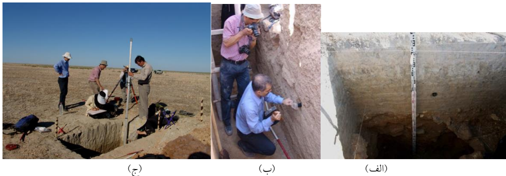
شکل ۹. فرایند و مراحل نمونه‌برداری با لوله پی‌وی‌سی جهت سن‌یابی لومینسانس نوری در نزدیک دیوار گران (الف) چاله - ترانشه حفر شده با اندازه مناسب (ب) عملیات نمونه‌برداری (ج) اندازه‌گیری فاصله نمونه تا سطح زمین.
