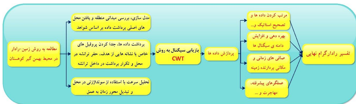
شکل ۳. روش زمین-رادار در محیط‌های بهمین گیر و الگوریتم پردازشی اعمال شده در این مطالعه.
