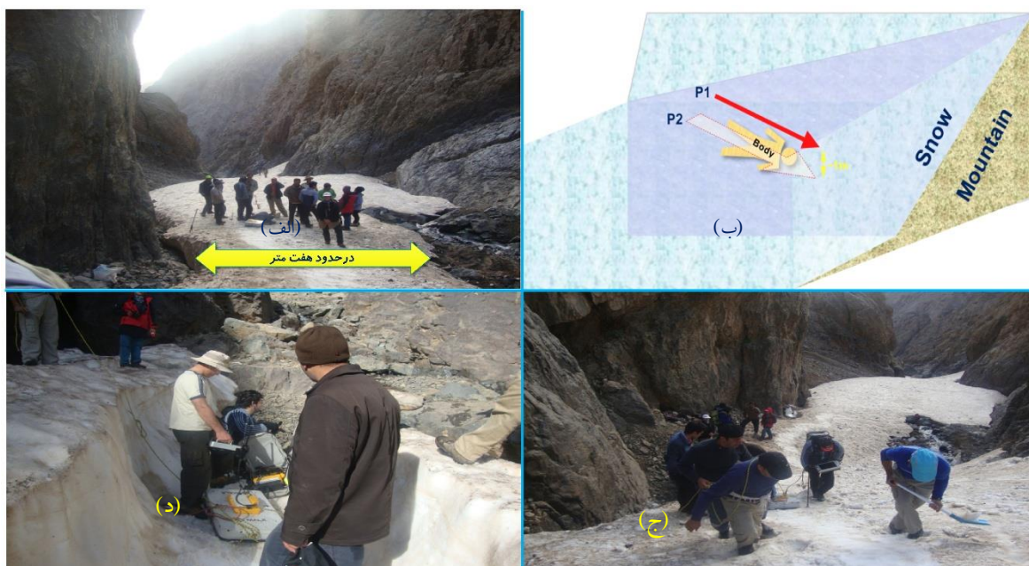
شکل ۱. محل برداشت داده‌ها (الف) طرح کلی نحوه برداشت مقاطع روی سطح و داخل ترانشه با توجه به موقعیت بدن کوهنورد مدفون (ب) برنامه‌ریزی و طراحی عملیات (ج) برداشت داده‌ها (د) حفر ترانشه و برداشت داده‌ها
