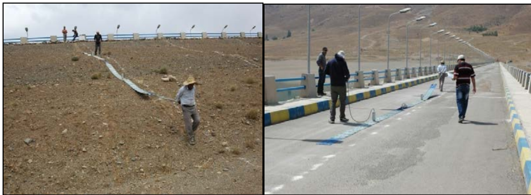
شکل ۶. نمایی از برداشت پروفیل‌های رادار نفوذی (الف) بر روی محور (ب) سطح شیبدار پایین دست سد خوانسار.
