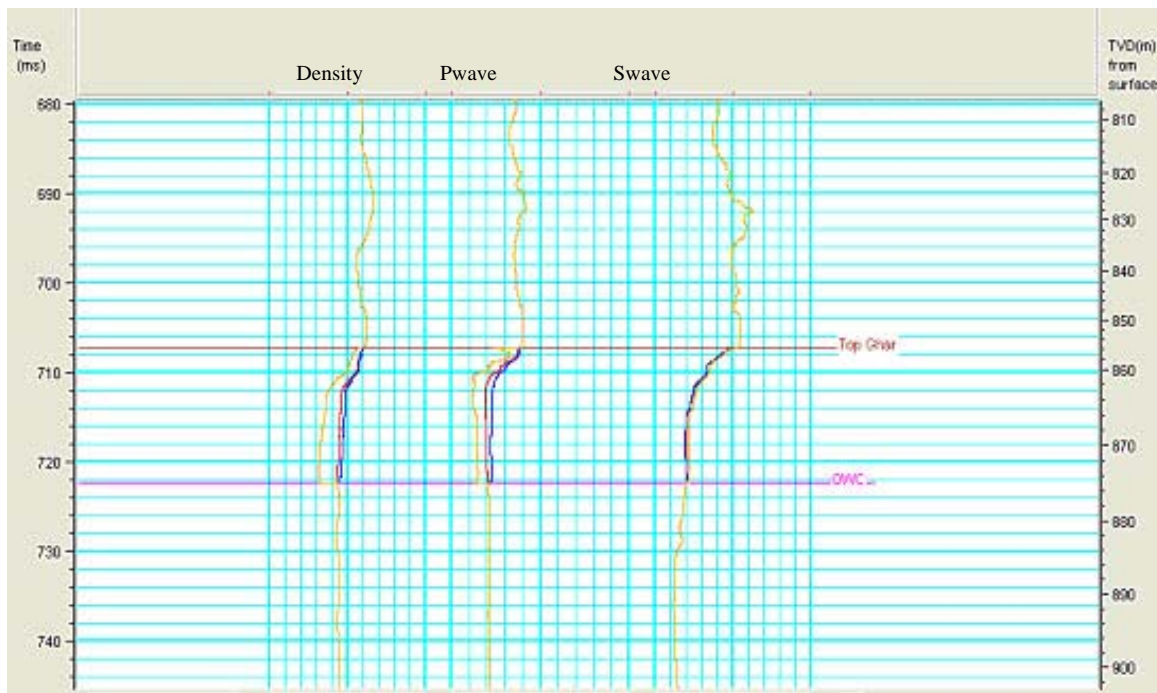
شکل ۳. مقایسه تغییرات Vs، Vp و چگالی در اثر تغییر نوع سیال در مخزن، نگار نارنجی مربوط به حالت گازدار، سرخ مربوط به حالت نفت‌دار و آبی مربوط به حالت آب‌دار است. همان‌طور که ملاحظه می‌شود با عبور از رأس مخزن مقدار این متغیرها کاهش می‌یابد. مقدار چگالی و سرعت موج تراکمی در حالت گازدار کمتر از دو حالت دیگر مخزن است. سرعت موج برشی تقریباً برای همه حالت‌ها برابر ولی مقدار آن در حالت گازدار اندکی بیشتر است. ناحیه مخزن به کمک دو افق (TOP Ghar و OWC) مشخص شده است.
