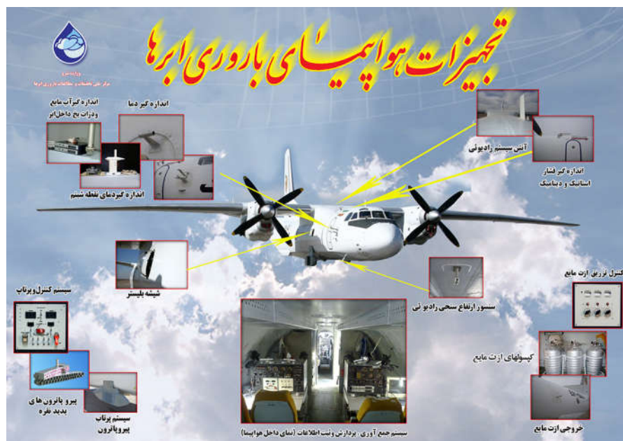
شکل ۲. حسگرهای نصب‌شده روی هواپیمای بارورسازی ابرها در ایران برای ثبت داده‌های هواشناسی هنگام اجرای عملیات بارورسازی ابرها
