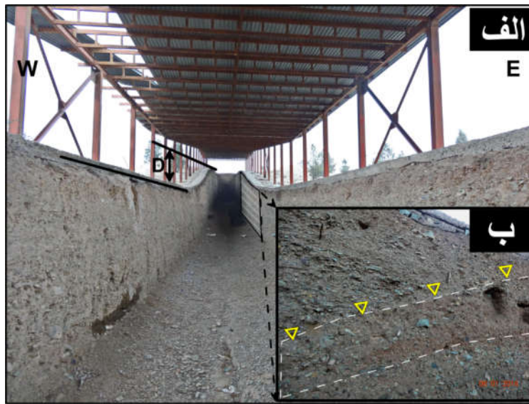
شکل ۳. تصویر ترانشه راندگی شمال تهران. (الف) جابه‌جایی شاقولی گسلش (D) (ب) نمای نزدیک از گسلش (خط‌چین) و خرده‌سنگ‌های جهت‌یافته (نگاه به سوی شمال)
