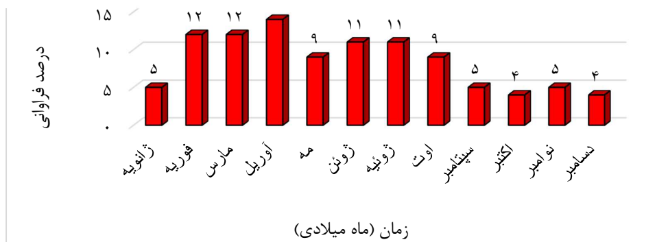
شکل ۳. درصد فراوانی رخداد باد با سرعت بیشتر از ۱۲ متر بر ثانیه برای هر ماه سال طی دوره آماری ۳۶ ساله در ایستگاه اهواز.
