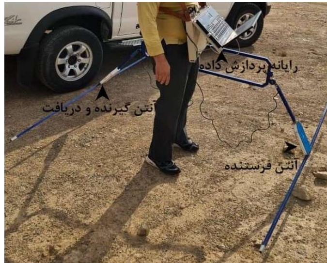
شکل ۴. طرح‌واره دستگاه GPR Zond-12e.
