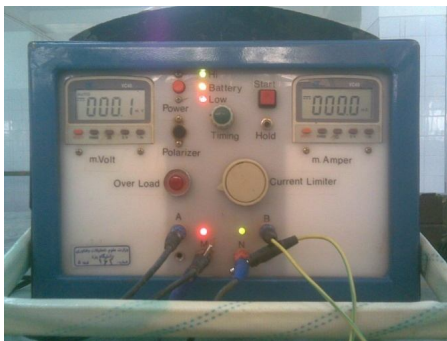
شکل ۵. دستگاه اندازه‌گیری مقاومت ویژه الکتریکی در آزمایشگاه (ساخته شده در دانشگاه یزد).
