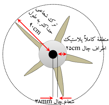
شکل ۲. منطقه مومسان و ترک‌های شعاعی ناشی از انفجار تک‌چال در توده گلسنگی سد گتوند علیا.
