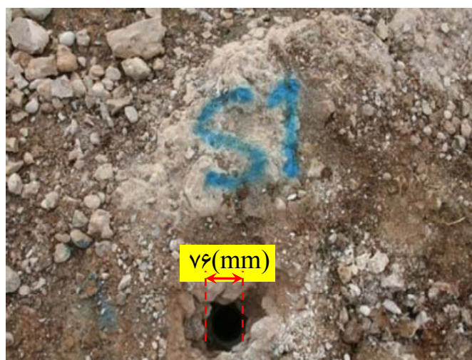
شکل ۱. تک‌چال انفجاری حفر شده در توده گلسنگی منطقه سد گتوند علیا.
