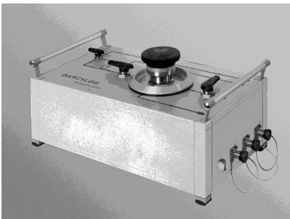
شکل ۲. دستگاه اندازه‌گیری نفوذپذیری خرده‌سنگ‌های حفاری، داریسی لاگ.
