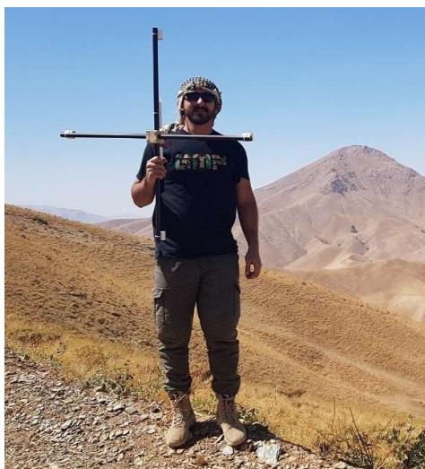
شکل ۶. اپراتور برداشت به شیوه تانسور کامل گرادبان مغناطیسی با استفاده از چهار حسگر با آرایش متقاطع.
