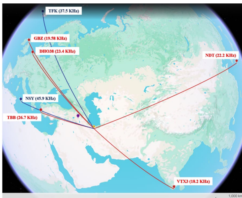
شکل ۱. موقعیت ایستگاه‌های فعال رهگیری شده فرستنده امواج VLF/LF که سیگنال آن‌ها در گیرنده TEH در زمان وقوع زمین‌لرزه مدنظر، دریافت شده است. نشانک زردرنگ ایستگاه گیرنده مؤسسه ژئوفیزیک دانشگاه تهران و نشانک بنفش رومرکز زمین‌لرزه خوی را نشان می‌دهند. ایستگاه‌های قرمز رنگ فرستنده امواج VLF و ایستگاه‌های آبی رنگ فرستنده امواج LF هستند.
